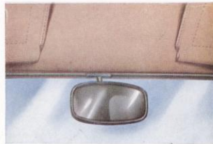
ACHTERUITKIJKSPIEGEL. Aangebracht in het midden boven de voorruit. Kan gemakkelijk worden versteld om een ruim uitzicht door de grote achterraut te krijgen.
