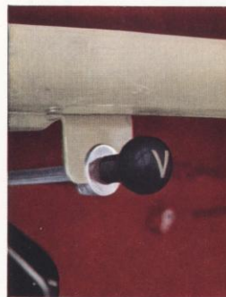
VENTILATIE. Tochtvrij door dit systeem, dat een regelbare luchtverversing van het interieur mogelijk maakt.
