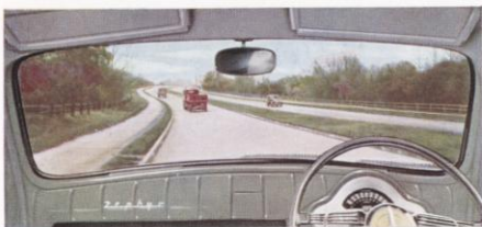
UITZICHT VOOR. De gebogen, anti-verblindende voorruit uit één stuk biedt een breed, onbelemmerd uitzicht.
