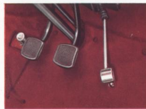
GASPEDAAL VAN HET LEPELTYPE verlicht het autorijden aanzienlijk, daar uw voeten zich niet hoeven in te spannen.
