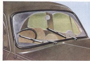
DUBBELE RUITENWISSERS van het vacuümtype vegen praktisch de gehele voorruit schoon en zijn van roestvrij staal.
