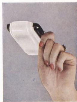
PLAFONDVERLICHTING met ingebouwde schakelaar verlicht het gehele interieur.
