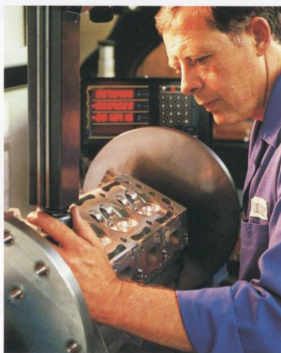
Inspectie van cilinderkop met behulp van computer
