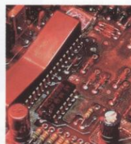
ABS-microprocessor Regelcircuit van ABS-systeem
