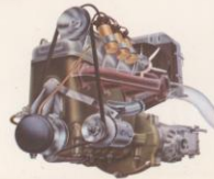
Moteur à trois cylindres deux-temps de 1000 cm 3
