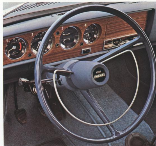
Het instrumentenpaneel van de 1301 Special: 1 - toerenteller, 2 - snelheidsmeter, 3 - benzinemeter met reservestand, watertemperatuurmeter, controlelampjes voor laadstroom en oliedruk, 4 - elektrische klok.
