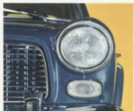
Harmonische grille, koplampen met a-symmetrische lichtbundels; rubber stootnokken op de bumperhoorns.
