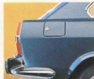
Fraai gelijnde achterzijde met afsluitbaar klepje voor de benzinedop; ook rubber stootnokken op de achterbumperhoorns.
