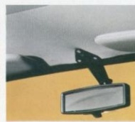
Verstelbare achteruitkijkspiegel met „anti-verblindingsstand“ en interieurverlichting (nog twee lampjes achterin!)
