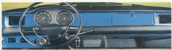
Perfekt uitzicht op de weg en een zeer compleet instrumentenpaneel met snelheidsmeter/kilometerteller, watertemperatuurmeter, benzinemeter en verkliekerlichten voor clijnoteurs, oliepeil, benzinereserve, groot licht en handrem. Tuimelschakelaars voor stadslicht, ruitenwissers, „aanjager“ en dashboardverlichting. Knop voor bediening ruitensproeiers.
