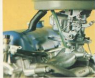
Dwarsgeplaatste, 4 cilinder 1221 cc. motor met een vermogen van 59 PK (SAE) / 4- en 5-deurs uitvoering 62 PK (SAE).
