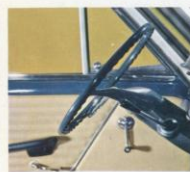
4-gesynchroniseerde versnellingen met stuurschakeling; armsteunen aan de portieren en 3 x beveiligde deursloten.
