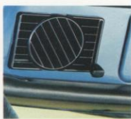
Aan weerszijden van het dashboard een verstelbaar luchtrooster met regelbare toevoer.
