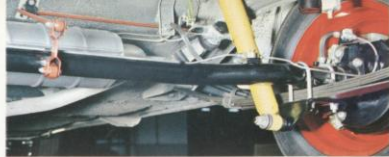
Vier schijfremmen! Om het remmen nóg efficiënter en zekerder te doen geschieden is de PRIMULA voorzien van een REMREGULATOR, die het remmoment op de achterwielen regelt. BIJ ELKE BELASTING.
