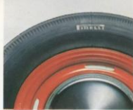
Schijfwielen met velgen 4.00-13 en PIRELLI BANDEN 145-13; 4- en 5-deurs: velgen 4½ J-13 en banden 155-13.
