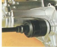
Voorwielaandrijving d.m.v. twee steekassen. Motor en versnellingsbak vormen een compact geheel.
