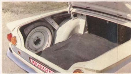
Coffre géant de 600 dm 3 : une véritable soute à bagages. A noter l'emplacemement rationnel de la roue de secours.
