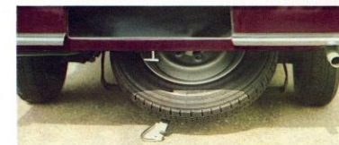
Het achter onder de vloer bevestigde reservewiel is eenvoudig te demonteren door het losdraaien van een bevestigingsmoer met behulp van de wielsleutel.
